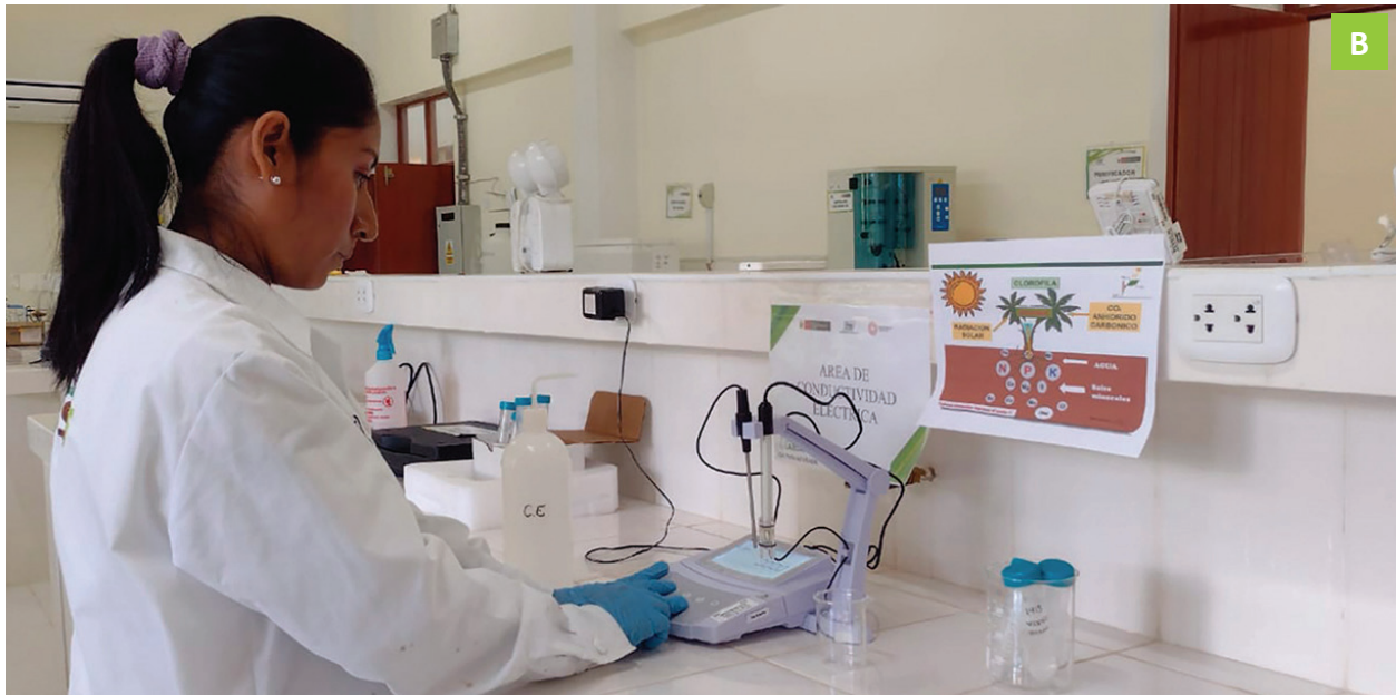
Figura 7. Determinación de la conductividad eléctrica: (A) Filtrado de la solución suelo previo a la lectura y (B) lectura con potenciómetro de mesa
