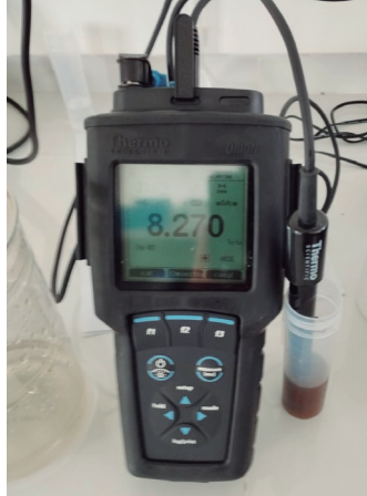
Figura 6. Determinación de la conductividad eléctrica en suspensión de suelo: agua 1:1 con potenciómetro portátil
