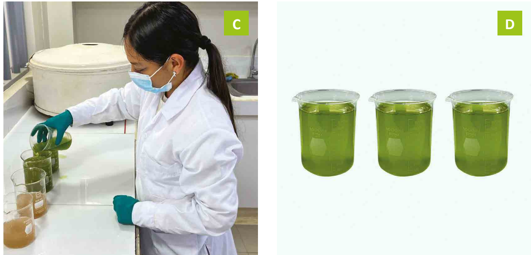
Figura 11. Escalamiento 2. A) Adición de 500 ml de agua a los vasos de precipitados conteniendo 20 g de nutriente, B) dilución del nutriente, C) adición de 200 mL del cultivo y D) muestras aforadas
