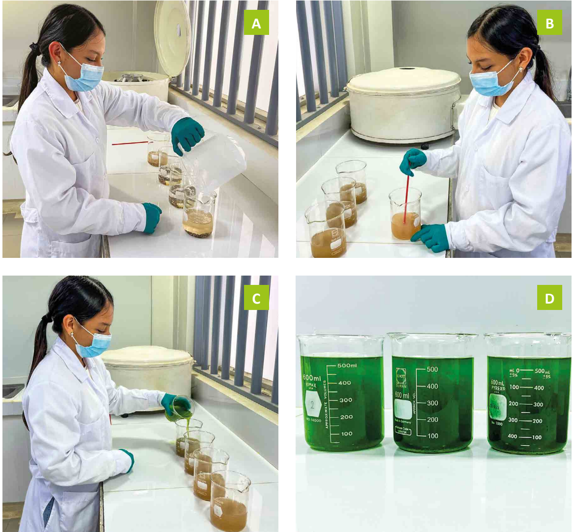
Figura 10. Escalamiento 1. A) Adición de 250 ml de agua a los vasos de precipitados conteniendo 10 g de nutriente, B) dilución del nutriente, C) adición de 100 mL del cultivo y D) muestras aforadas
