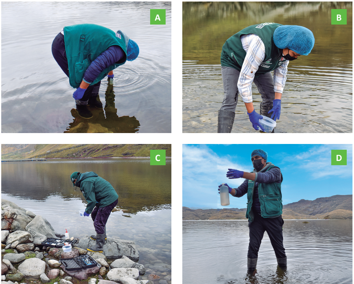
Figura 10. Procedimiento de toma de una muestra en diferentes puntos del cuerpo de agua de manera simultánea. (A) Muestreo simple, (B) muestreo simple, (C) muestreo simple y (D) muestra compuesta
