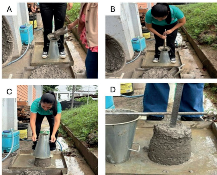
Figura 8. Colocación de la mezcla de concreto fresco en el molde troncocónico del ensayo de revenimiento (A), compactación de la mezcla mediante varillado dentro del molde (B), retiro vertical del molde troncocónico para permitir el asentamiento libre de la mezcla de concreto (C), medición del revenimiento del concreto después de retirar el molde, determinando la consistencia y trabajabilidad de la mezcla (D).
