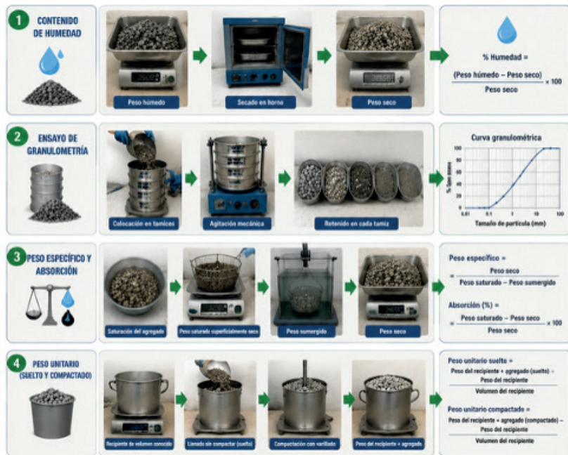
Figura 6. Caracterización de agregado fino y grueso.
