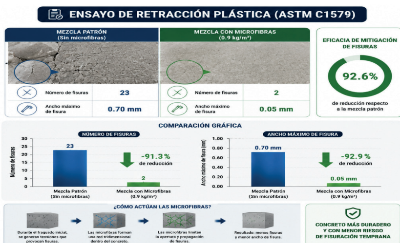
Figura 15. Comparativa de ensayo de retracción plástica de concreto patrón y con microfibras.
