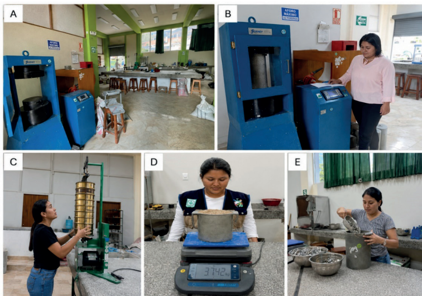
Figura 2. Vista general del laboratorio de concreto, con bancos, taburetes y equipo de ensayo (A). Prensa hidráulica para ensayos de compresión de concreto (B). Juego de tamices y soporte para caracterización de agregados (C). Balanza digital y molde cilíndrico para pesar agregados (D). Moldes, recipientes y herramientas para preparación y mezcla de concreto (E).
