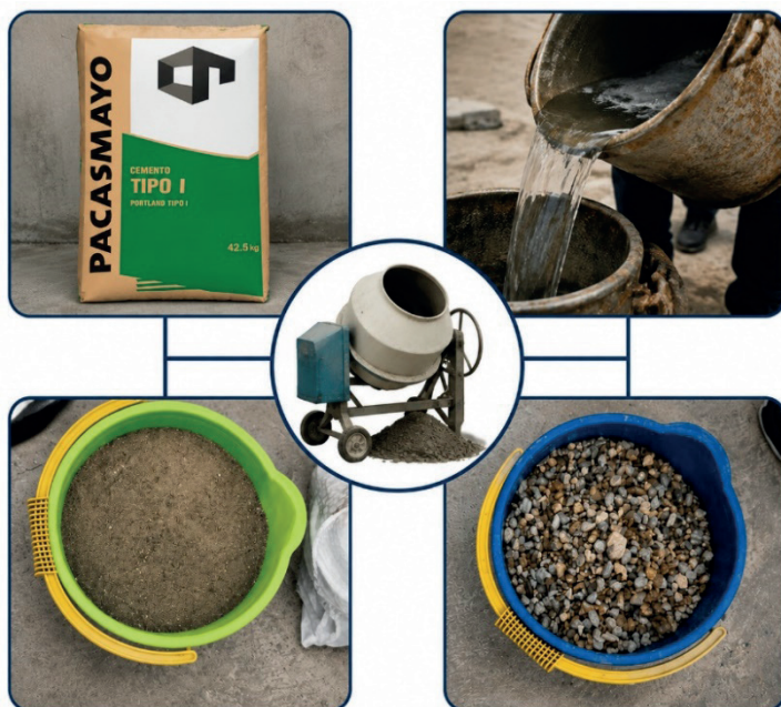
Figura 3. Materiales convencionales empleados en la elaboración de concreto.
