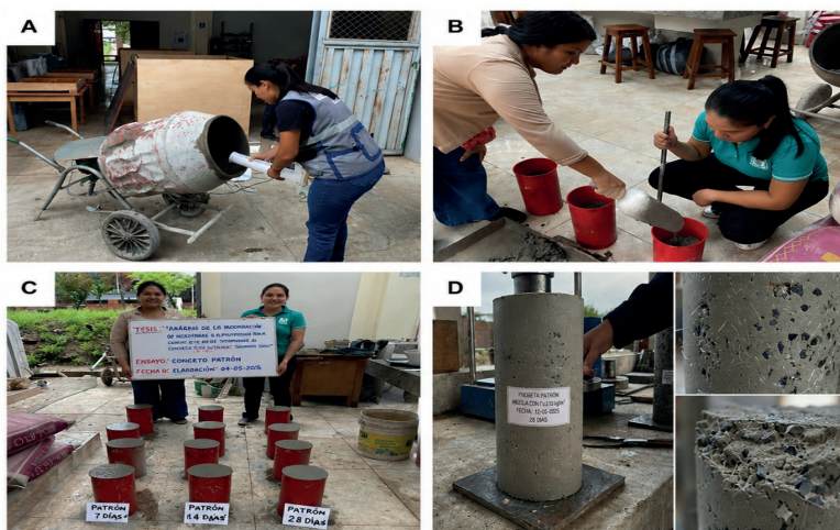
A: Vertido del concreto en los moldes cilíndricos. B: Compactación del concreto mediante varillado en capas. C: Probetas de concreto patrón identificadas por edades de ensayo (7, 14 y 28 días). D: Ensayo a compresión de probeta cilíndrica de concreto patrón y detalle de la fractura.
