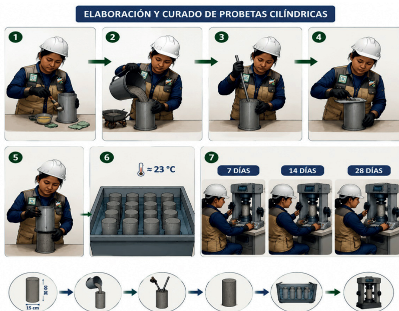
Figura 9. Elaboración, curado y ensayo de resistencia a compresión de probetas.
