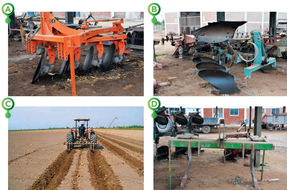
Figura 13. Diferentes tipos de implemento agrícola, arado de disco (A). Arado de reja (B). Arado para aperturar surco (C). Arado subsulador (D). Fotos: León Cosme Cerna.
