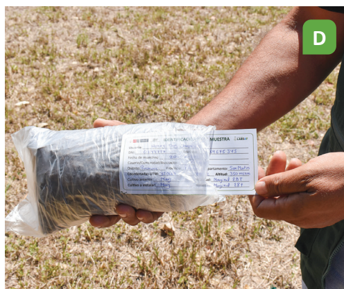
Figura 8. Proceso del muestreo de suelos. A) Limpieza y realización del hoyo, B) colecta del suelo, C) desterronamiento y eliminación de raicillas, y D) separación y etiquetado de la muestra (adaptado de Díaz-Chuquizuta et al., 2025)
