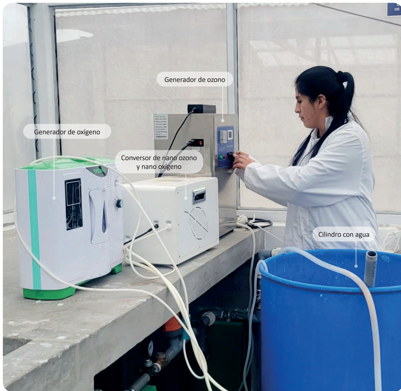
Figura 32. Ozonificación del agua de riego mediante el uso de un convertor de nano ozono y nano oxígeno, acoplado a un generador de oxígeno y un generador de ozono en el interior de una casa malla.
