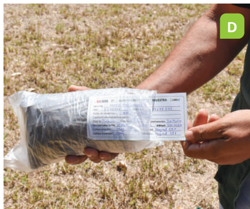
Figura 8. Proceso del muestreo de suelo. A) Limpieza y realización del hoyo, B) colecta del suelo, C) desterronamiento y eliminación de raicillas, y D) separación y etiquetado de la muestra (adaptado de Díaz-Chuquizuta et al., 2025)
