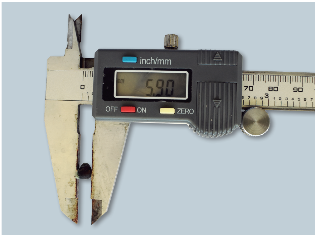
Figura 55. Medición del ancho de una semilla del cultivo de algodón ( Gossypium barbadense L.)
