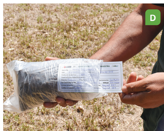
Figura 8. Proceso del muestreo de suelos. A) Limpieza y realización del hoyo, B) colecta de suelo, C) desterronamiento y eliminación de raicillas, y D) separación y etiquetado de la muestra (adaptado de Díaz-Chuquizuta et al., 2025)
