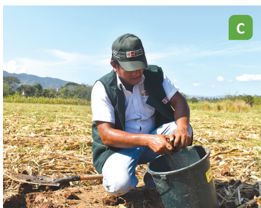
Figura 8. Proceso del muestreo de suelos. A) Limpieza y realización del hoyo, B) colecta de suelo, C) desterronamiento y eliminación de raicillas, y D) separación y etiquetado de la muestra (adaptado de Díaz-Chuquizuta et al., 2025)
