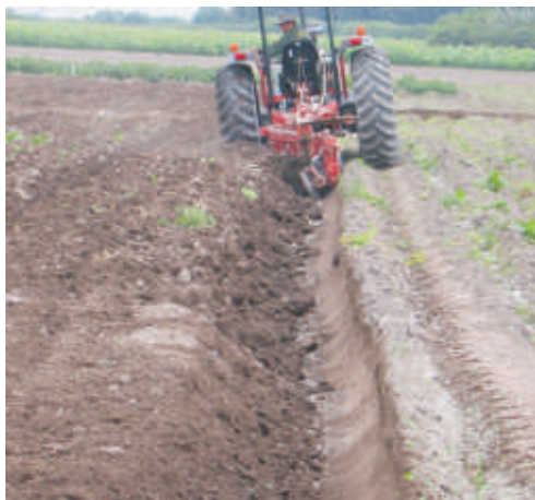
Foto 39. Aradura de terreno con arado de discos
