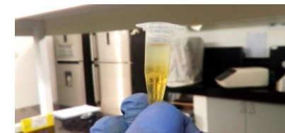
FORMACION DEL ANILLO DE PRECIPITACION DE ACIDOS NUCLEICOS POR EL USO DE ISOPROPANOL HELADO
