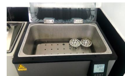
INCUBACION DEL TEJIDO CON EL BUFFER DE EXTRACCION PARA LISIS CELULAR, DEGRADACION DE LIPIDOS Y PROTEINAS
