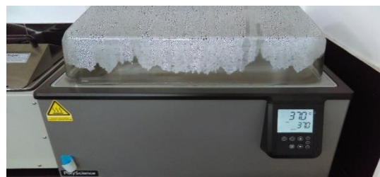
INCUBACION DEL PRODUCTO DE LA EXTRACCION A 37°C PARA PERMITIR LA ACCION DE LAS ARNASAS
