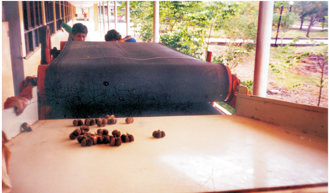
Foto 111: Descascarado mecánico de cápsulas de sacha inchi con trilladora múltiple de bandas KHOLER 10
