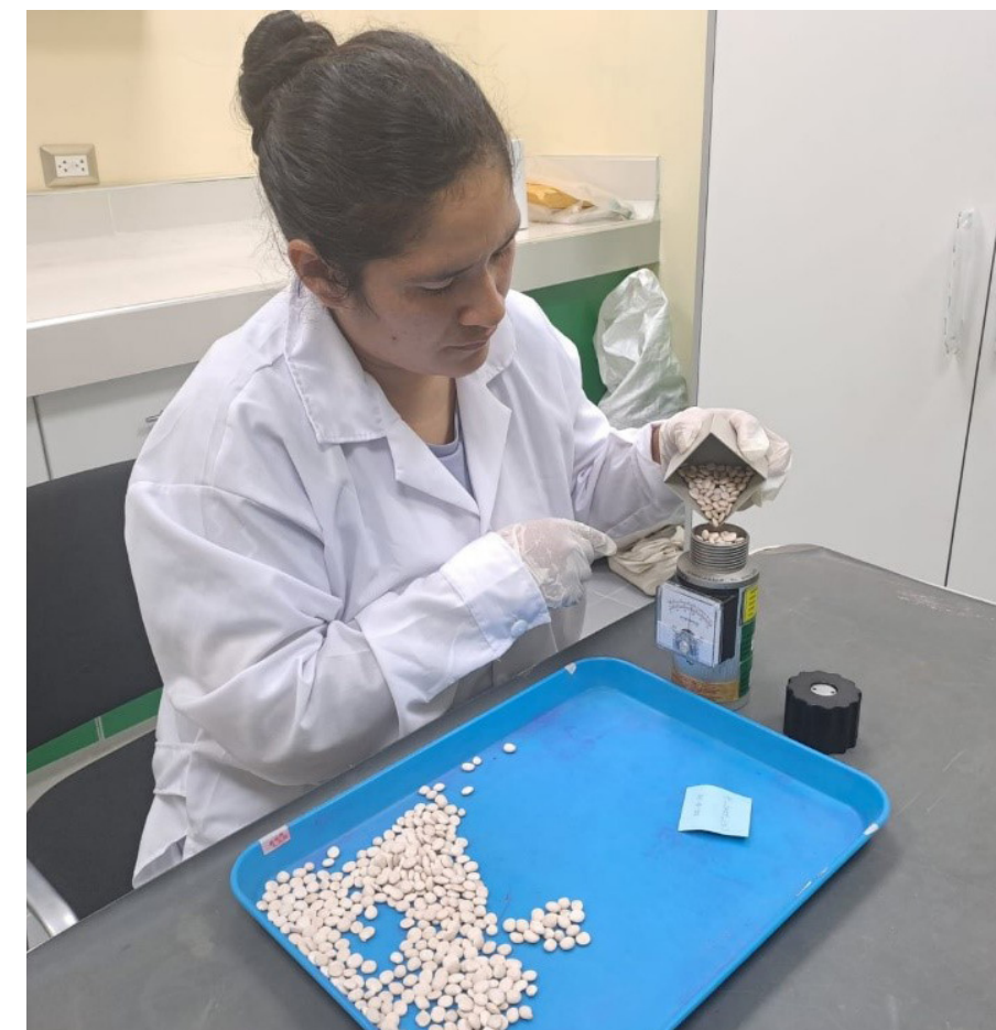
Figura 7. Uso de un medidor de humedad digital para la determinación del contenido de humedad de semillas de tarwi
