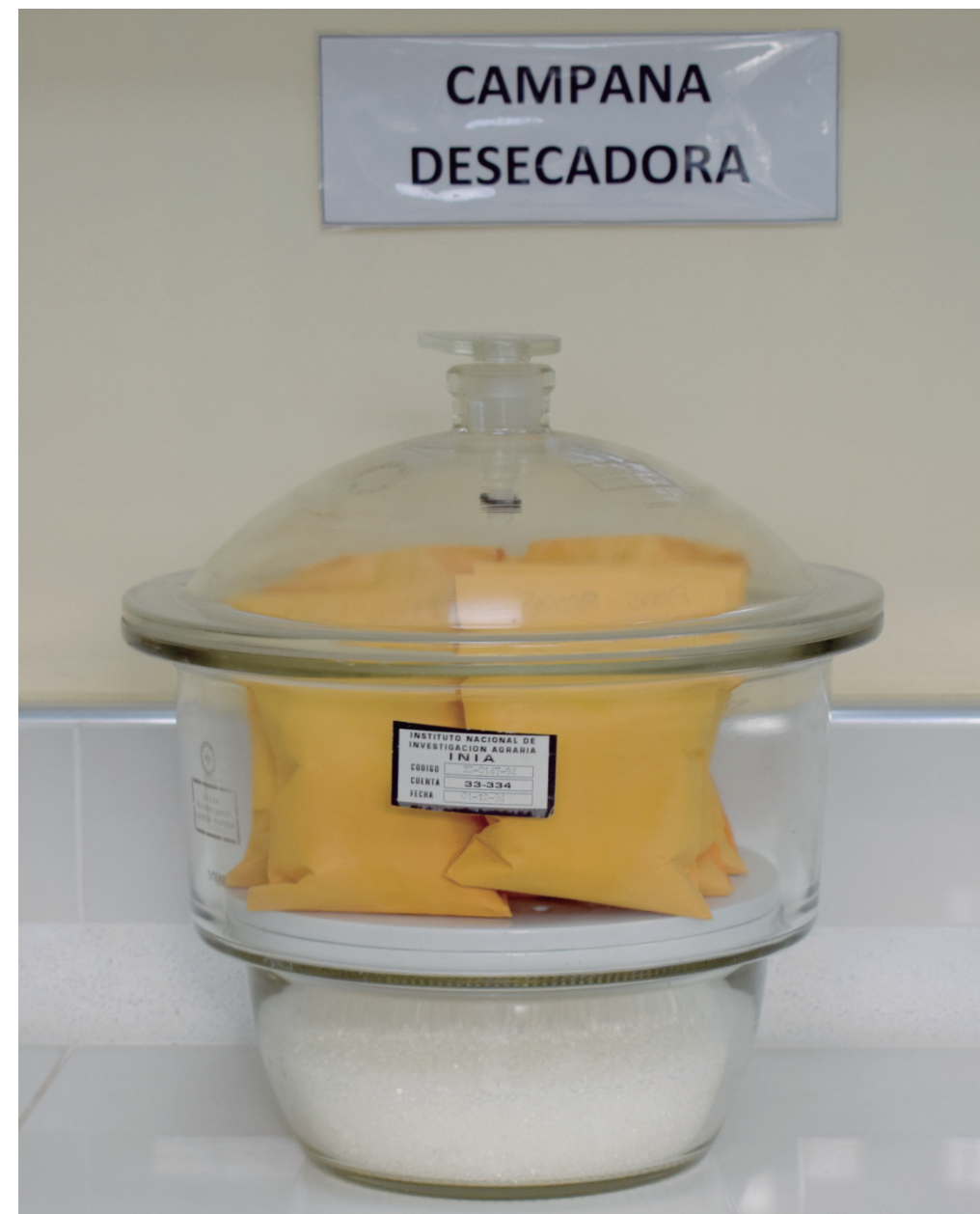
Figura 8. Desecador con gel de sílice utilizado para el secado de semillas de tarwi
