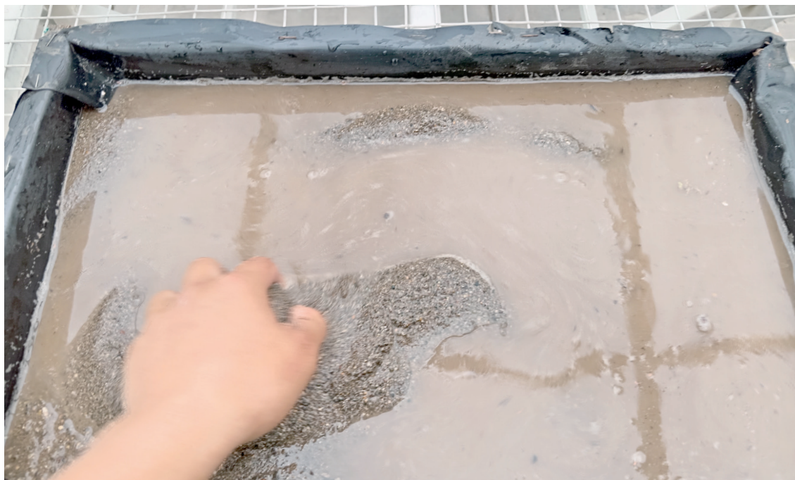
Figura 11. Lavado de arena para su desinfección
