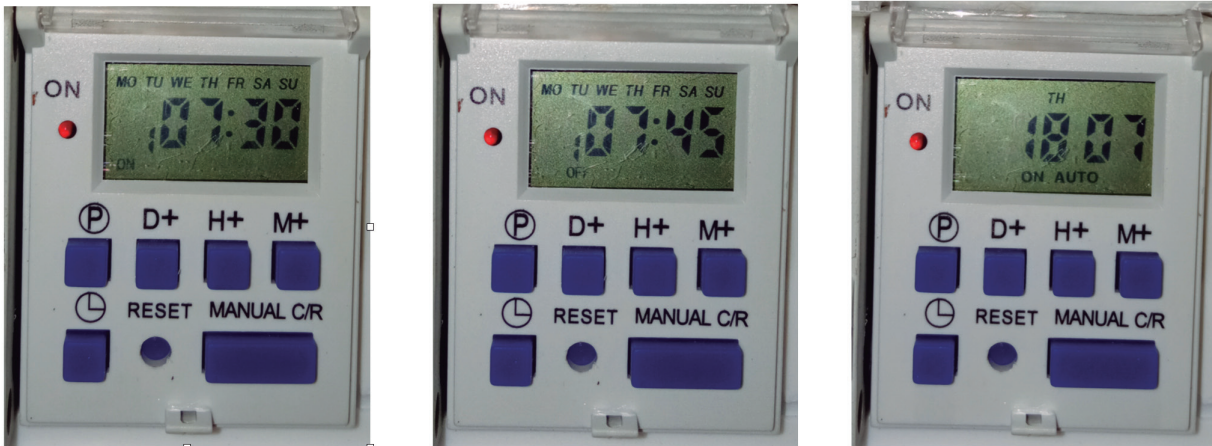
Figura 41. Programación del temporizador
