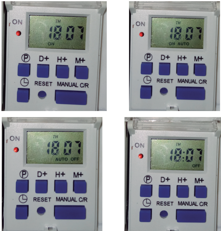
Figura 42. Configuración manual y automática
