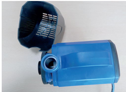
Figura 30. Bomba abierta para la revisión de limpieza
