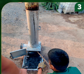
Durante el proceso pirólltico se debe controlar el tiempo para evitar la producción de ceniza.
