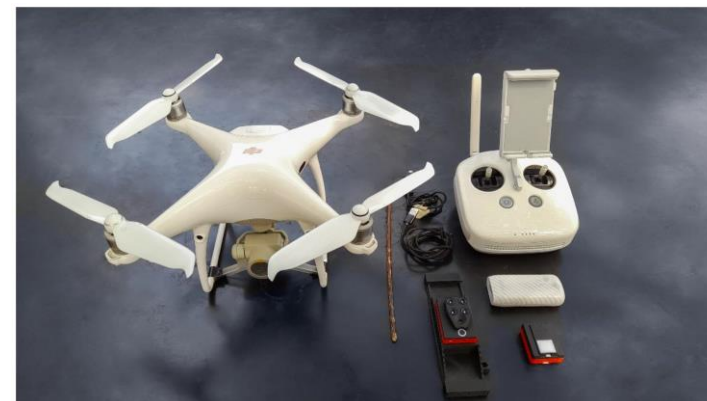
Equipo utilizado en la recolección de datos. UAV y radio control, y cámara Parrot Sequoia
