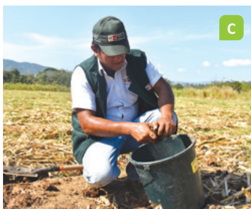
Figura 8. Proceso del muestreo de suelo. A) Limpieza y realización del hoyo, B) colecta del suelo, C) desterronamiento y eliminación de raicillas, y D) separación y etiquetado de la muestra
