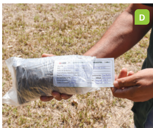
Figura 8. Proceso del muestreo de suelo. A) Limpieza y realización del hoyo, B) colecta del suelo, C) desterronamiento y eliminación de raicillas, y D) separación y etiquetado de la muestra
