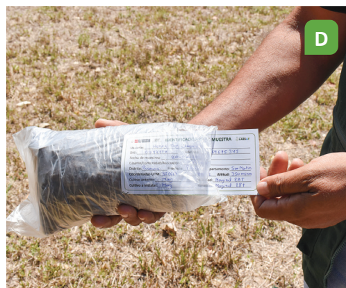
Figura 8. Proceso del muestreo de suelos. A) Limpieza y realización del hoyo, B) colecta de suelos, C) desterronamiento y eliminación de raicillas, y D) separación y etiquetado de la muestra (adaptado de Díaz-Chuquizuta et al., 2025)
