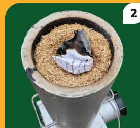
Agregar la biomasa al horno pirolítico y encenderlo
