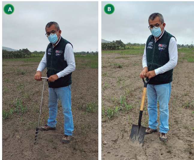
Figura 5. Materiales para muestreo de suelos con (a) barreno y (b) pala de hoja plana
