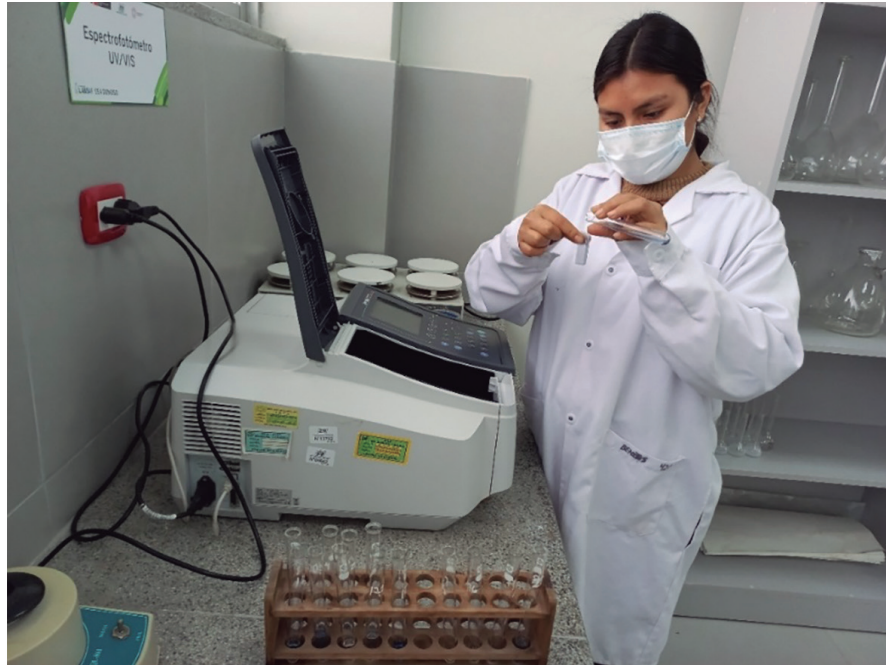
Figura 30. Lectura en el espectrofotómetro UV/Vis a 882 nm
