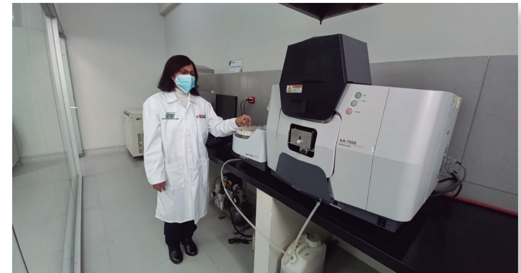
Figura 31. Lectura de la concentración de los diferentes elementos en el Espectrofotómetro de Absorción Atómica
