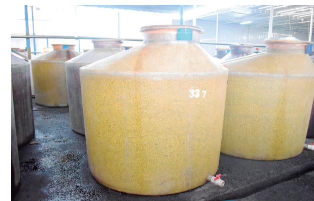
Figura 8. Tanques de fermentación para la elaboración de aceituna verde estilo sevillano
