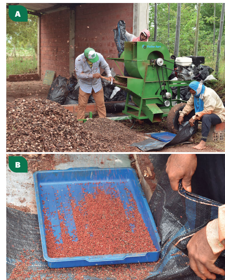
Figura 41. Trilla mecanizada de achiote: (A) labor de trillado con máquina trilladora y (B) semillas resultantes del proceso de trillado
