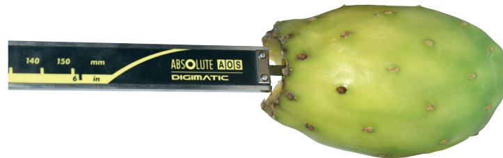
Figura 36. Medición de la depresión de la cicatriz del receptáculo del fruto de tuna
