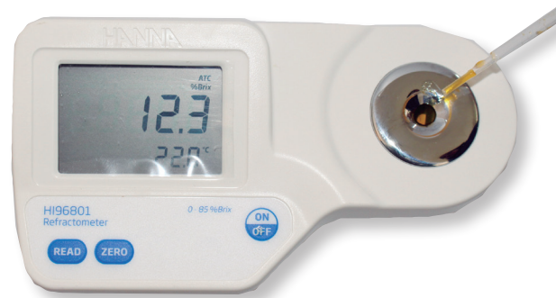
Figura 41. Medición de grados Brix en una muestra de jugo de fruto de tuna
