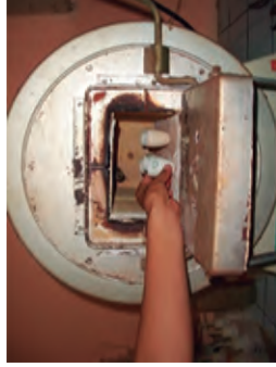
Calcinación de las muestras en la mufia.
