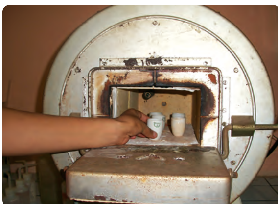
Figura 25. Muestras en crisoles y puestos en la Mufla para determinar el carbono.
