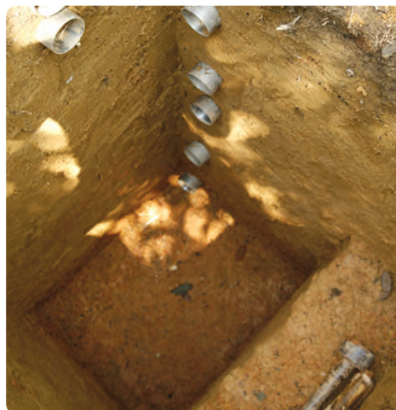
Figura 26. Diseño de calicata para muestrear densidad aparente del suelo.
