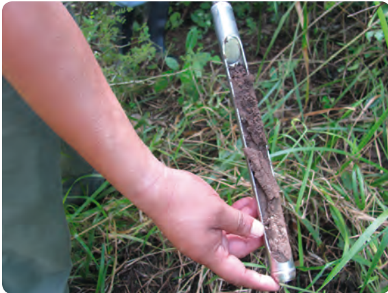
Figura 11. Calicata de muestreo para medir Carbono en el suelo.
