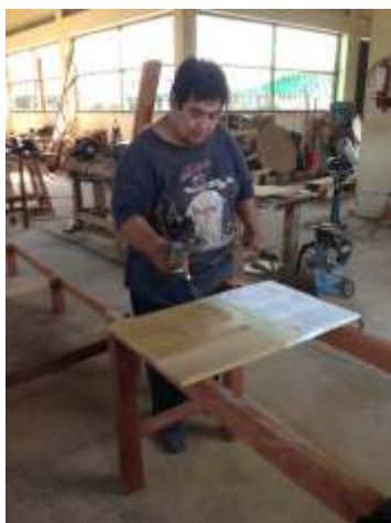
Foto 23. Realizando el acabado de los tableros
