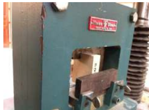
Foto 18. Ensayo de cizallamiento
