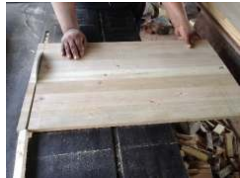
Foto 22. Despunte de los tableros
