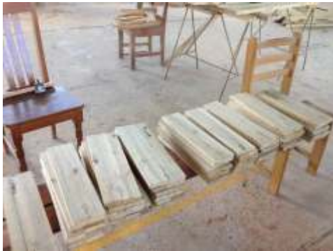
Foto 15. Pares de tablillas encoladas y fraguadas
